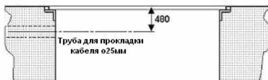
Рис. 4. Схема по монтажу трубы для прокладки кабеля
