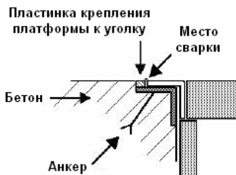
Рис. 5. Схема крепления платформы к краю приямка
